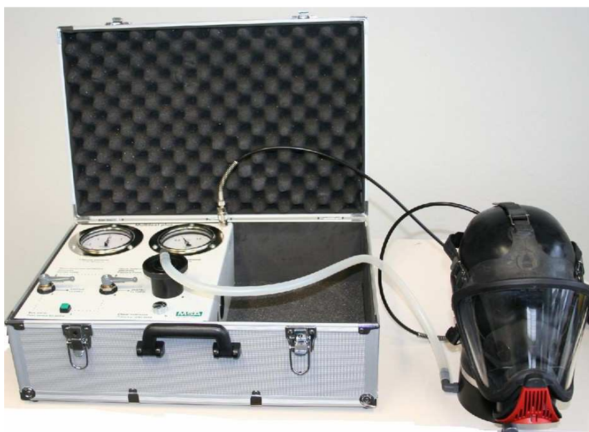
Рисунок 14-Прибор контрольно-измерительный Multitest
